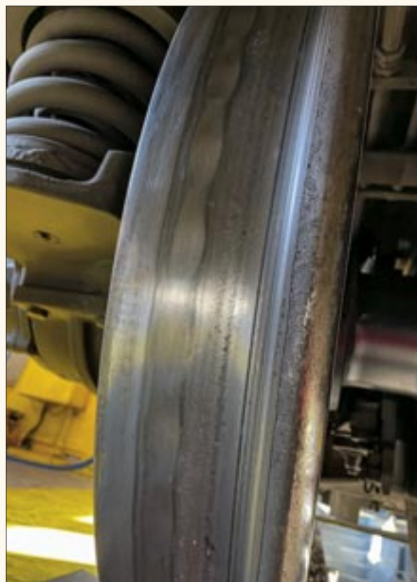
Schlupfwellen (Polygone) an einem Radsatz eines Doppelstockwagens der Schwarzwaldbahn.
